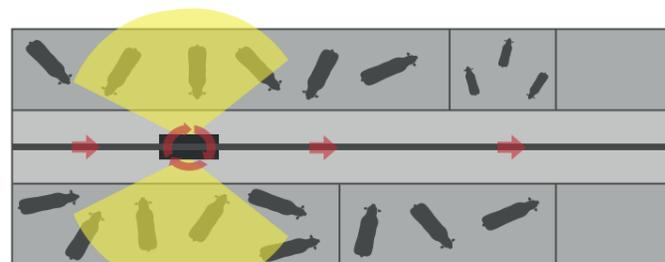
Doomax sur chariot rail + zoom x 25 + Son + Commande éclairage séparée - Évolutive - 2 axes 180° & 360° continu - Programmable - Système alerte & automouv' - Chariot complet avec moteur et variateur.
