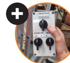
Ouverture et fermeture pneumatique télécommandée
