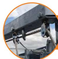
Ouverte et fermeture grâce à une corde et un système de poulies
