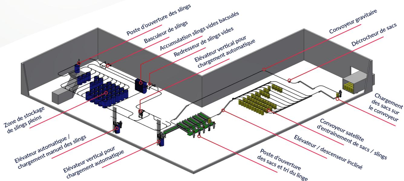
**Astron est un convoyeur aérien qui permet généralement l'accumulation de charges unitaires** (pouvant aller jusqu'à 80 kg par chariot) dans plusieurs types d'industries.
