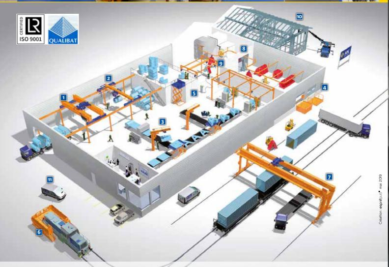
☐ Pont roulant process ☐ Pont roulant ☐ Potence ☐ Table de quai ☐ Table élévatrice ☐ Table mobile ☐ Portique ☐ Monorail tubulaire ☐ Poutre roulante manuelle ☐ Charpente métallique ☐ Services, maintenance, pièces détachées, modernisation
