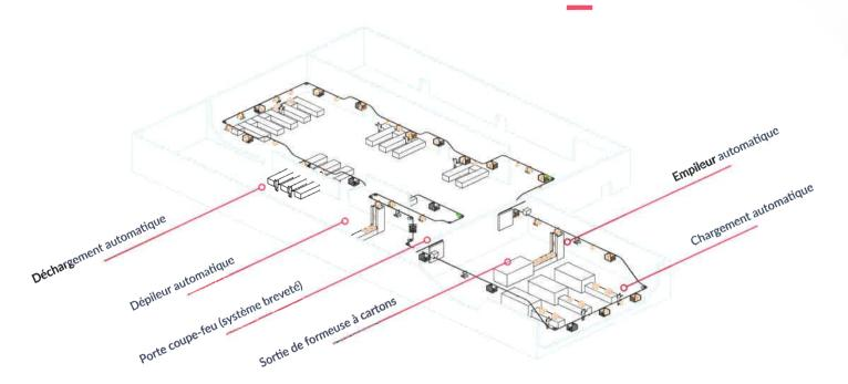
**Orion est un convoyeur à corde.** Il s'agit d'un système de manutention aérienne simple, propre et silencieux, qui demande peu d'entretien.
