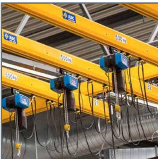
Les poutres roulantes encastrées ont été spécialement étudiées pour les endroits avec peu de hauteur libre, c'est-à-dire là où une construction standard ne peut fournir la hauteur de levage souhaitée. Les poutres roulantes rehaussées entre les voies de roulement augmentent la hauteur de levage.
