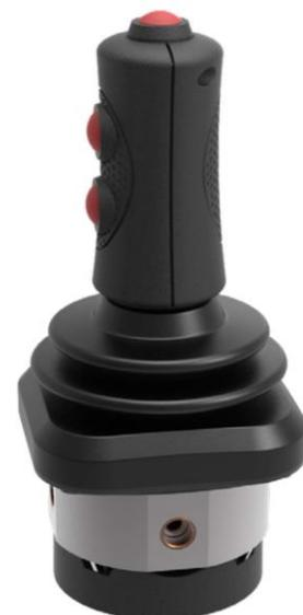
Le manipulateur V27 est un produit extrêmement robuste couramment utilisé pour les applications électrohydrauliques. Il est de conception très compacte. Un système de crantage ou de frein à friction du levier est proposé en option. La durée de vie et la fiabilité sont importantes grâce à la technologie sans-contact à effet Hall. Avec ses multiples interfaces et ses nombreuses poignées, le manipulateur V27 s'adapte facilement à toutes les applications.
