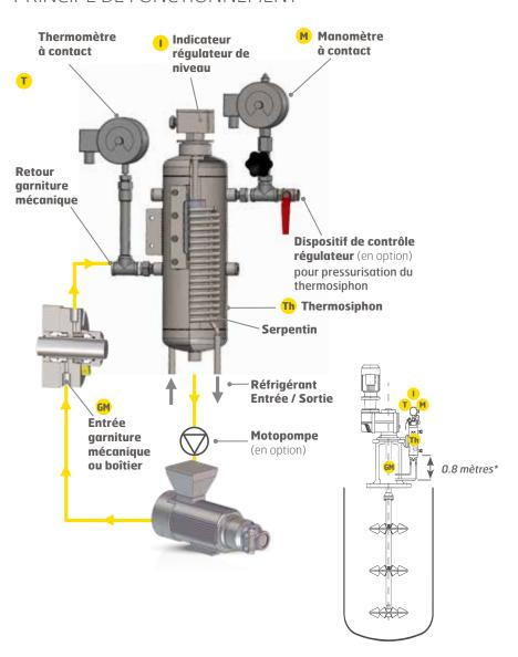
La gamme LATTYlub Pot permet de réguler et de contrôler la température de vos systèmes d'étanchéité afin d'améliorer la durée de vie de vos équipements.
