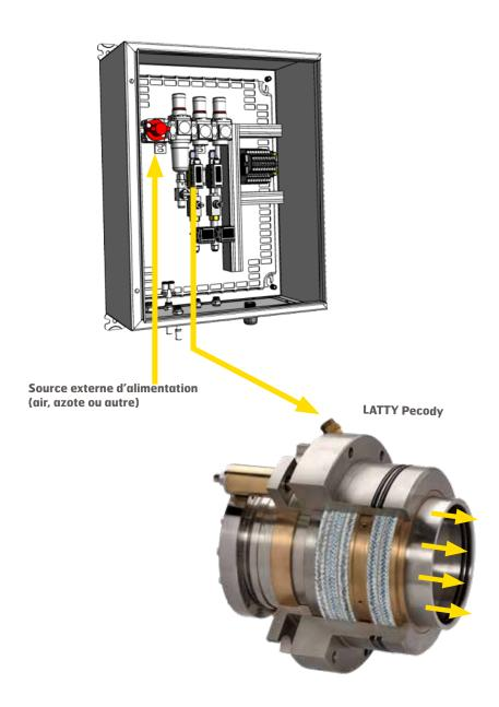
Le dispositif contrôleur-régulateur (DCR) est un système d'alimentation pour les étanchéités nécessitant un apport gazeux.
