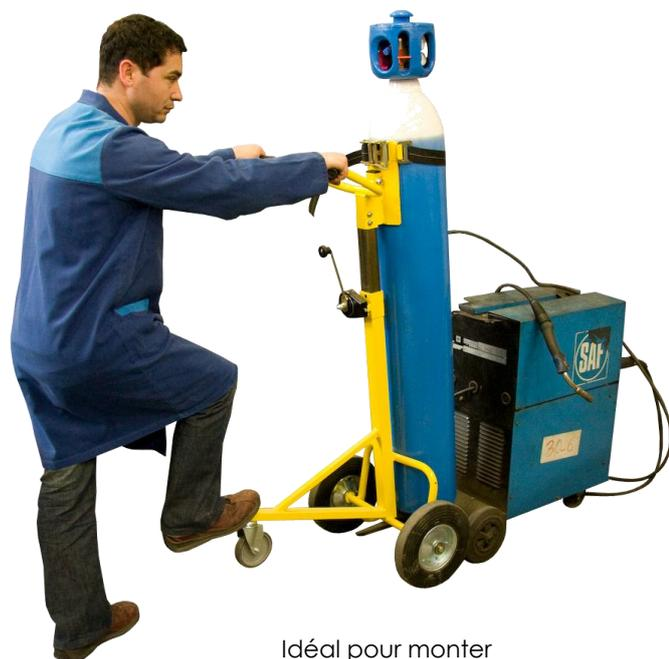
Idéal pour monter ou descendre une bouteille d'un poste à souder.
