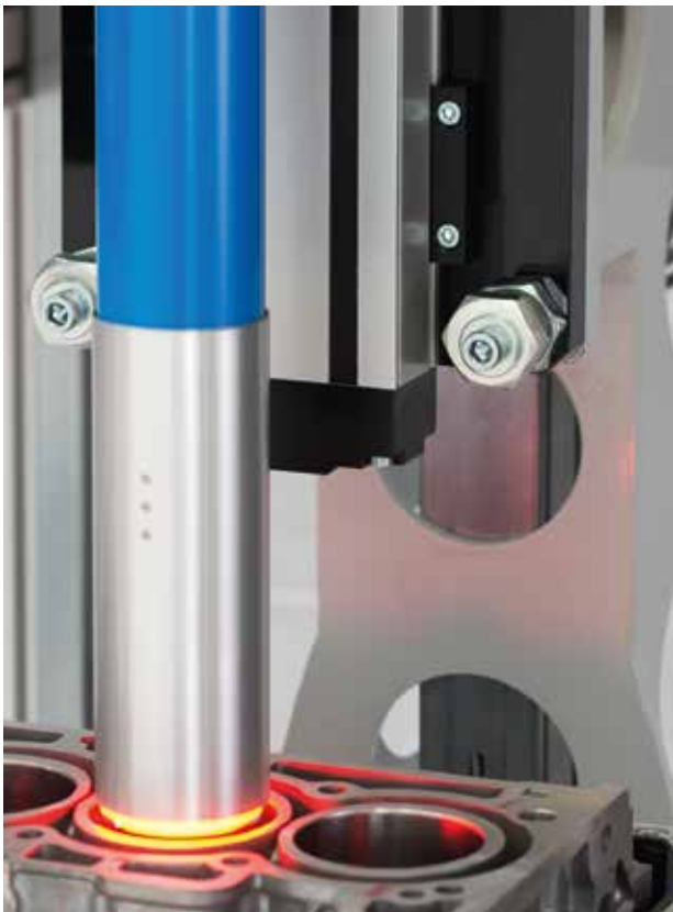
Inspection optique de surfaces dans les alésages
