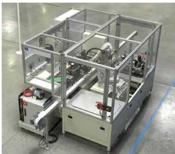
Station de mesure en ligne automatisée pour les engrenages
