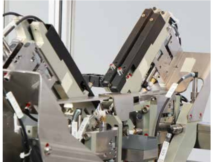
Système tactile conçu spécifiquement pour les pièces à mesurer
