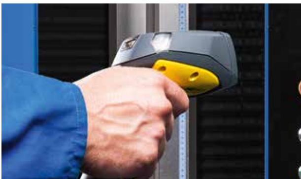
Lecteur de code-barres : sélection du plan de contrôle ou saisie des données
