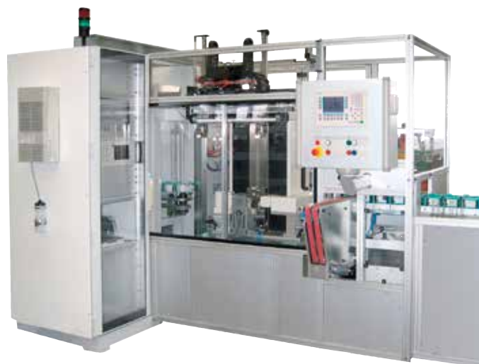
Opticline automatisé pour la mesure des soupapes de moteur, intégré dans une unité de fabrication
