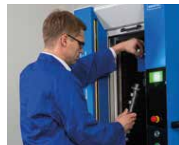
Chargement simple de la machine de mesure grâce au réglage rapide de la contre-poupée
