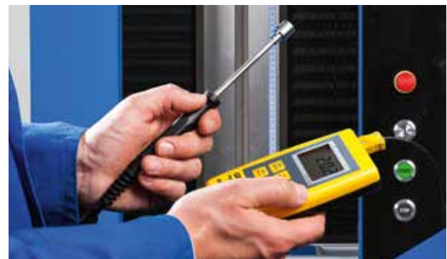
Détection de la température de la pièce
