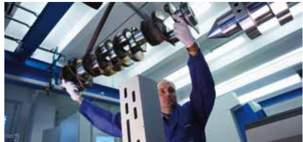
Utilisation en fabrication, chargement d'un vilebrequin lors de l'autocontrôle par l'opérateur
