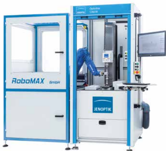
Exemple d'intégration d'un système Opticline CA618 avec robot et station de chargement
