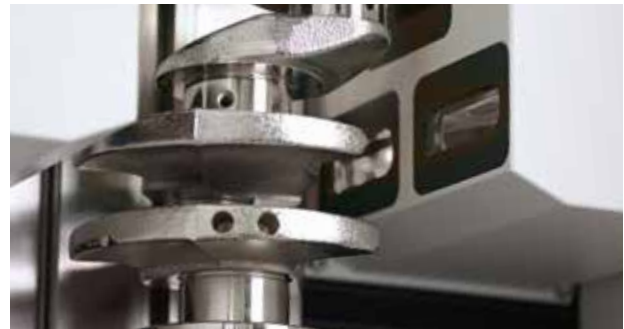
Opticline C1023-75AE : Mesure de vilebrequins avec un système de caméra spécialement optimisé, un axe C de haute précision et un système de mesure angulaire de haute résolution
