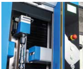
Barrière immatérielle intégrée pour la protection de l'opérateur
