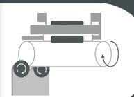
Blocage et mise en rotation des produits cylindriques lors de l'étiquetage grâce à un système de levage à galets
