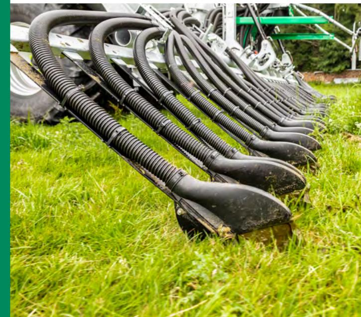
Les tuyaux de 43 mm de diamètre sont très flexibles et suivent le tracé de la machine sans contrainte. La surface intérieure lisse optimise le débit. Les tuyaux noirs spécialement conçus par SAMSON assurent une résistance unique aux UV.
