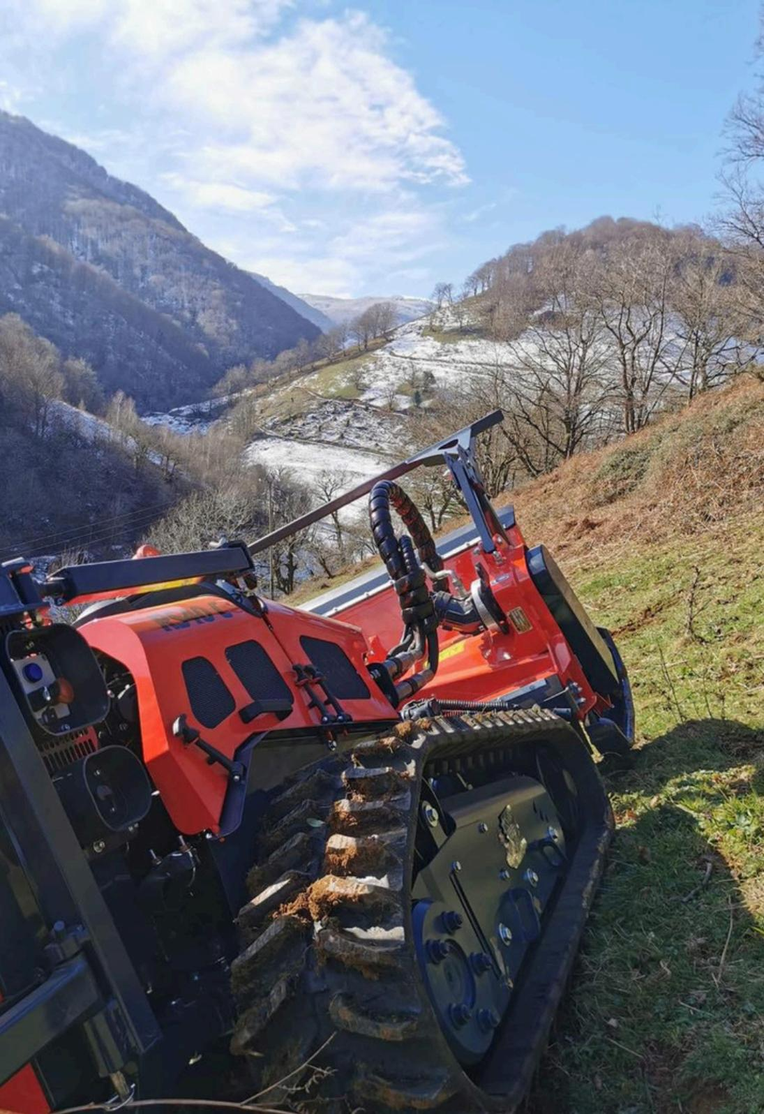
Le **ROBOSLOPE** est équipé de trois pompes hydrauliques montées en série dont, une pour chaque train de chenille et une pour l'entraînement de l'outil.
