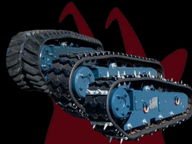
Le système anti-déchenillage et de mise en tension hydraulique automatique limite fortement le risque de déraillement de la chenille et permet d'améliorer la sécurité et la productivité tout en préservant leurs longévité.
