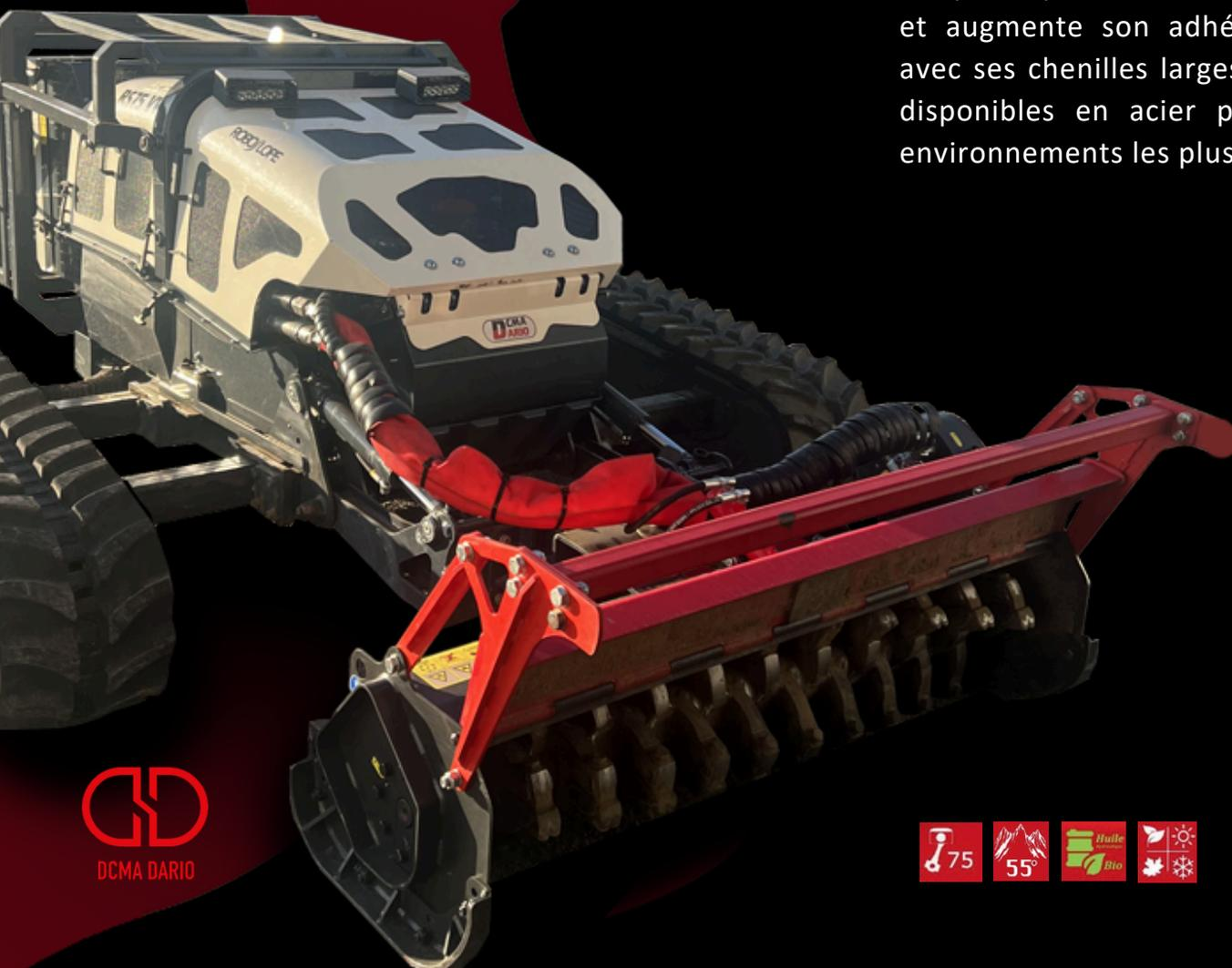
Le RS75VV est le plus gros modèle de la gamme Roboslope. Tout comme les autres, il est aussi muni d'une voie variable qui lui permet d'élargir son empattement de 800mm grâce à ses trains de chenilles à écartement hydraulique indépendant.
