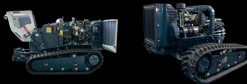
Les ROBOSLOPE sont équipés de moteurs industriels diesel Perkins à faible émission permettant ainsi de réduire son empreinte carbone.
