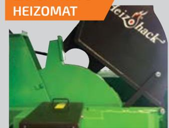
Soufflerie à volant d'inertie de 130 kg : éjection des plaquettes puissante + réserve de puissance.
