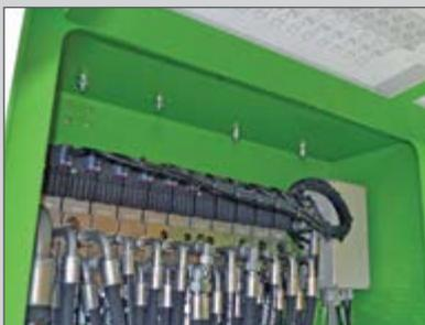
Bloc hydraulique avec levier pour fonctionnement manuel
