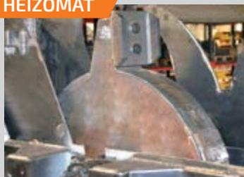
Soufflerie à volant d'inertie d'1 T = réserve de puissance
