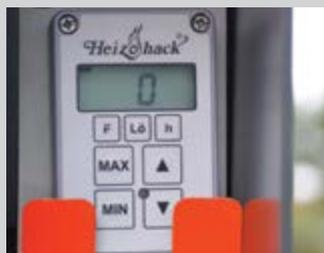
Système de commande no-stress Heiðhack HE 002 pour réguler l'avancée du bois en fonction de la puissance d'entraînement.
