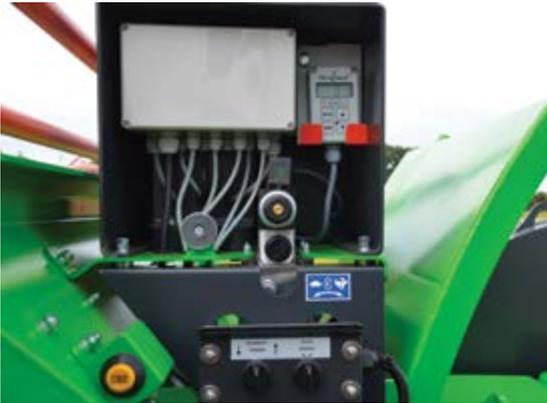
Le système d'amenée régulé par le no-stress permet de gérer l'avancée du bois de façon optimale afin d'assurer la qualité de plaquettes produites selon la vitesse de rotation du rotor et la puissance d'entraînement.
