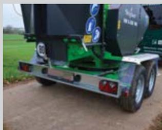
Châssis routier 80 km/h + barre de protection
