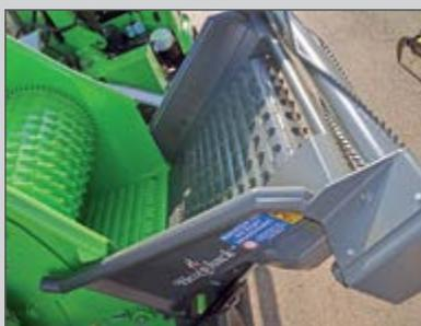
Table d'alimentation avec 2 tapis séparés, relevable pouvant servir d'entonnoir + rouleau ameneur motorisé en bout de table
