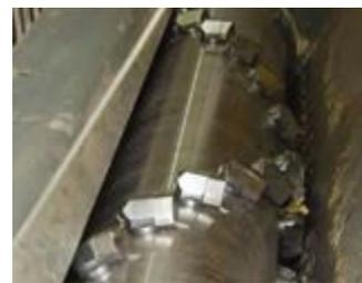
Rotor ø 30cm à rotation lente (60 tr / min) constitué de 36 ou 43 dents de coupe en carbure de tungstène (800 h de broyage) + contre-couteau réversible.
