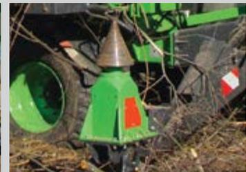
Cône fendeur à 1 moteur en option (cf p.23)
