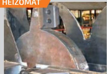
Soufflerie à volant d'inertie d'1 T = réserve de puissance
