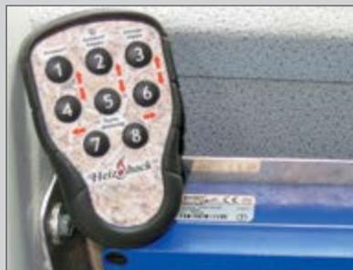
Télécommande radiocommandé pilotage de la goulotte d'éjection
