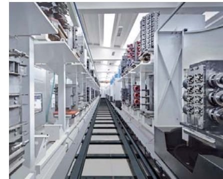
Huit centre de travail horizontal: production de boîtes de transmission et réducteurs
