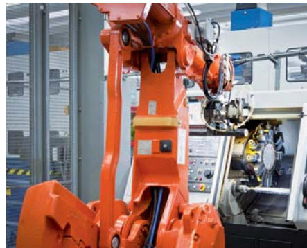
Vingt îlots de tournage robotisé
