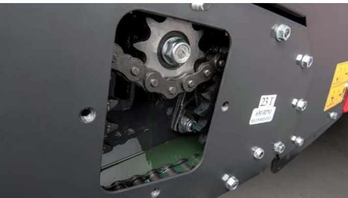
Organes de transmission à bain d'huile: durée illimitée, la chaîne n'a plus besoin d'être remplacée.
