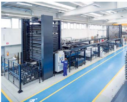
Installations de découpe laser robotisées
