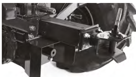
Anhängerkupplung für Anhänger bis zu 14.000 kg Crochet de remorquage pour les remorques jusqu'à 14 000 kg
