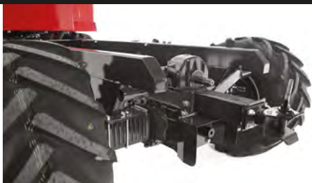
Lastschaltbare Heckzapfwelle Prise de force arrière indépendante
