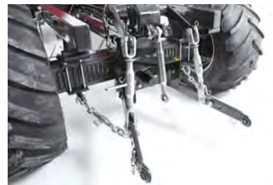
3-punkt Heckhydraulik Relevage hydraulique arrière avec attelage à 3 points
