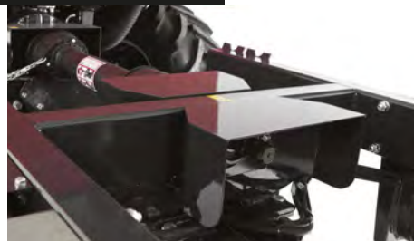
Lastschaltbare Zentralzapfwelle Prise de force centrale indépendante
