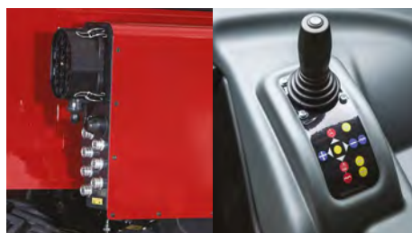
Hydraulische Varianten mit Schnellkupplungen vorne/hinten der Kabine Variantes hydrauliques avec raccords rapides avant/arrière la cabine
