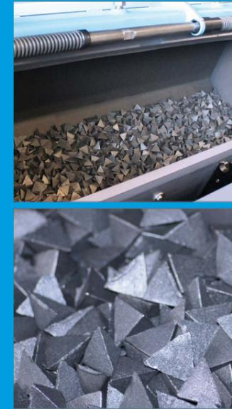
Le traitement est réalisé en cuve rotative. Les pièces sont brassées dans une charge de médias spécialement défini pour le type de matière.
