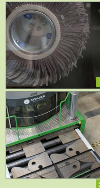
Nous disposons également de machines de brossage permettant l'ébavurage en panoplie de pièces à plat. Le traitement est réalisé par un carrousel de brosses. Les pièces sont maintenues par dépression ou magnétisme. Les brosses rotatives, qu'elles soient métalliques ou à lamelle abrasive) assurent une attaque de tous les angles des pièces.
