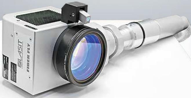
La durée de vie prévue du laser est supérieure à 100 000 heures de marquage, grâce à l'utilisation de diodes au "single emitter" et à la construction complètement intégrée de la partie optique. FiberFly est basé sur une source laser à fibre optique avec un refroidissement entièrement à air pour les puissances de 20W, 30W, 50W, 100W, 200W et 500W.
