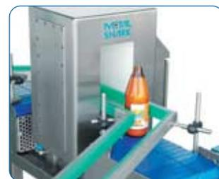
METAL SHARK® pour convoyeur pour bouteilles JAR2
