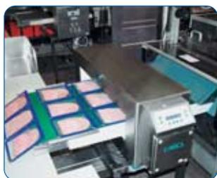
METAL SHARK® BD en sortie de ligne de thermoformage
