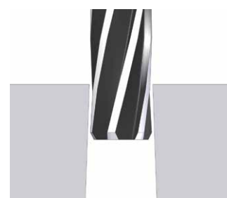
Alésage conique (sortie trop grande)
