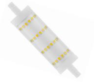
Puissance 15W = Ø 28 x 118 mm Faisceau 300° Dimmable 2 000 lm / 2 700 K IRC ≥ 80 Durée de vie env. 25 000 h
