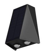
Noir Eclairage direct et indirect Puissance 3x 0,9W 154 x 80 x 100 mm Faisceau 15° à 120° 150 lm / 3 000 K IP 64
