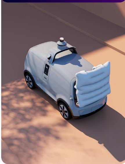
Nuro : Véhicule de livraison autonome de 3ème génération avec airbags
