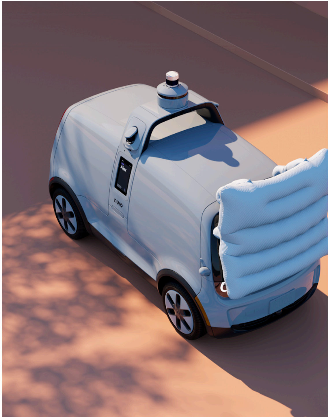
Nuro (USA) Véhicule de livraison autonome de 3ème génération avec airbags extérieurs
