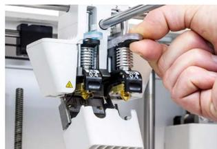
**Print core BB** Buses à permutation rapide pour matériaux de support hydrosolubles et de fabrication. Disponibles en 0,25, 0,4 et 0,8 mm
