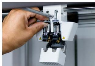
**Print core CC** Buse en acier trempé pour l'impression de composites abrasifs en verre et en fibre de carbone. Disponible en 0,4 et 0,6 mm
