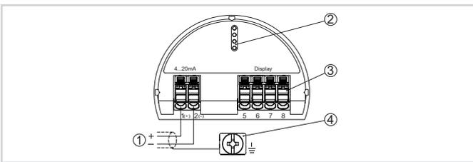
Compartiment électronique et de raccordement de boîtier à chambre unique (exemple)
