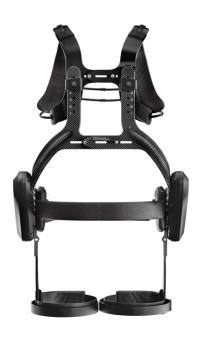
Grâce à une chaîne de degrés de liberté passifs, l'exosquelette permet toute la liberté de mouvement de l'utilisateur.
